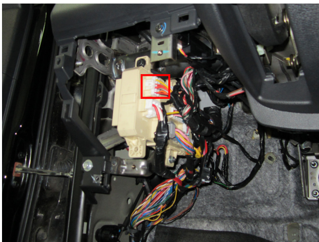
Рис.5 Место подключения к силовым цепям запуска двигателя
