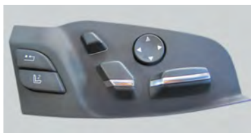
Рис. 3. Фото блоков управления кресел: а) панель управления дополнительными функциями кресел; б) переключатель регулировки положения заднего кресла
